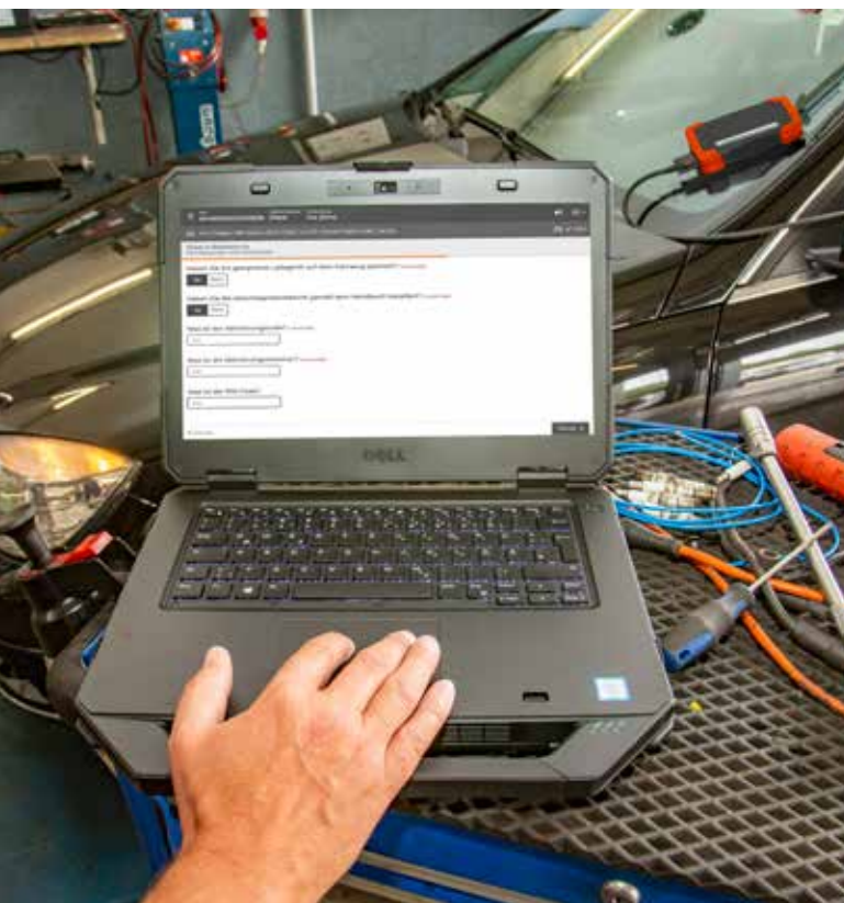
Sobald die Remote-Box angeschlossen ist, kann der Monteur Aufgaben auswählen und am Monitor die Ferndiagnose auslösen.
